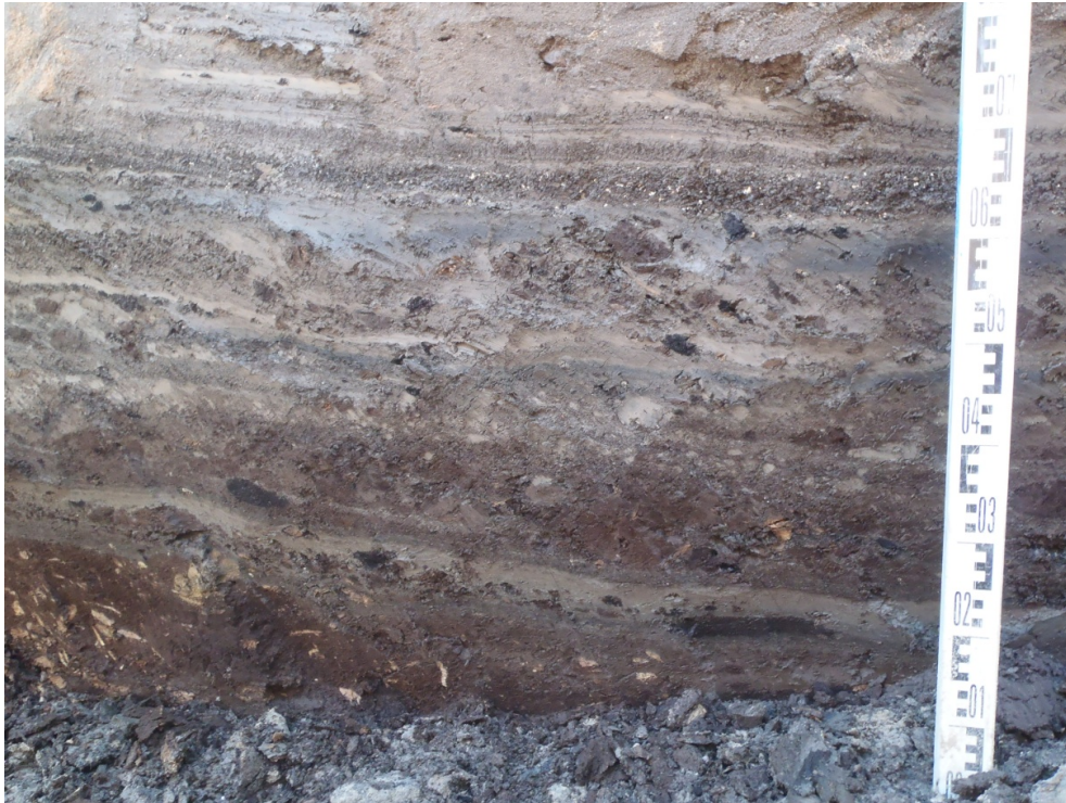
Afb. 15. De vulling van de teensloot (S3) van de middeleeuwse dijk: laagjes klei, veen, brokjes geoxideerd veen, en bovenin zandig en gruisig materiaal.
